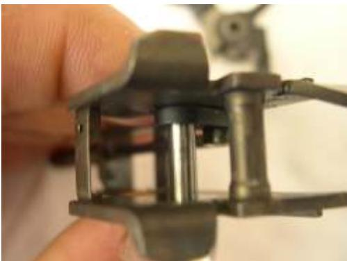
À gauche : sur cette vue de dessus du bloc platine , on aperçoit l'axe du marteau qui le traverse et maintient la chaînette; elle-même axée sur la bielle de percussion.
